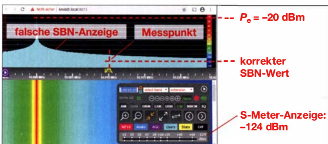
Bild 9: Messung des Seitenbandrauschens des KiwiSDR im Abstand von 10 \text{ kHz} zum Trägersignal (siehe Text)
