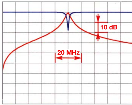
Bild 5: Durchlassbereich S_{21} (rot) und Rückflussdämpfung S_{11} (blau) des mit Fi1 realisierten 50-MHz-Vorfilters; Simulation mit RFSim99
