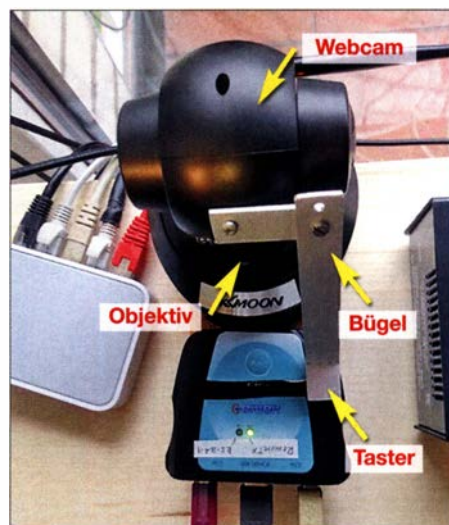
Bild 1: Die ferngesteuerte Webcam betätigt mithilfe des angeschraubten Bügels den darunter befindlichen Taster des USB-Umschalters. Foto und Screenshot: DC4KU
