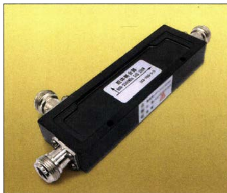
Bild 10: Dieser preisgünstige kommerzielle Richtkoppler ist für Messungen im 13-cm-Band gut geeignet und hat 40 dB Auskoppeldämpfung.
