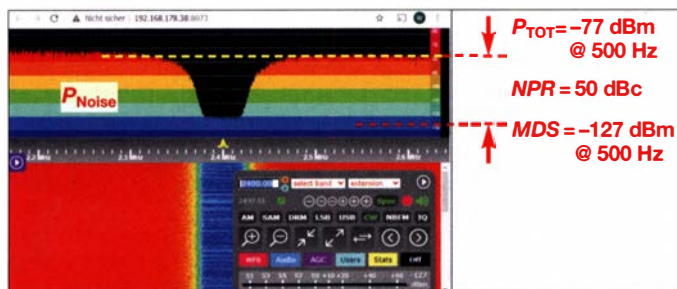
Bild 13: Ermittlung des Rausch-Leistungs-Verhältnisses (NPR) des KiwiSDR
