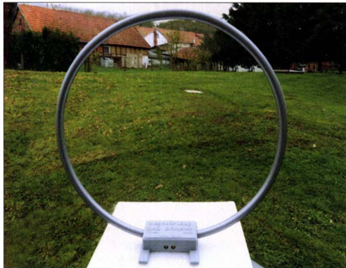
Bild 1: Magnetantenne aus PE-X-Rohr und einem Ständer aus dem 3-D-Drucker; im Rohr befindet sich entsprechend zusammenschaltetes Flachbandkabel.
