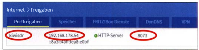
Bild 6: Freigabe des Ports 8073 für das Gerät kiwisdr mit der IP-Adresse 192.168.178.54 im Router
