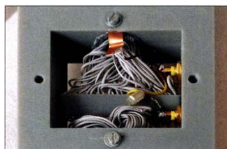
Bild 4: Unterseite des Ständers mit den Verbindungen der Flachbandkabelenden und der Kontaktstelle zum Rohr
