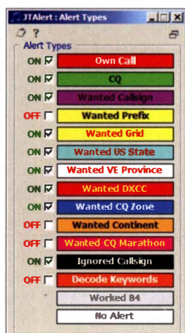
Bild 3: Die auswählbaren Auslöser für akustische Alarme sind auch in ihrer visuellen Darstellung konfigurierbar.
