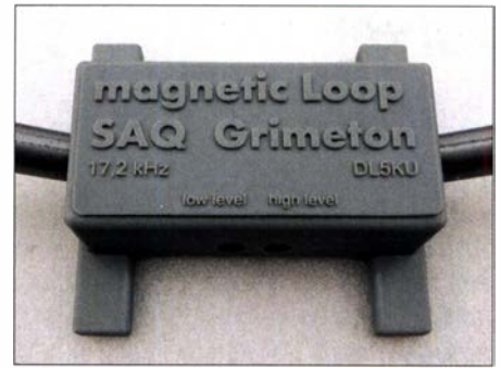
Bild 5: Ständer aus dem 3-D-Drucker für die Magnetantenne
