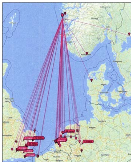
LA9AKA (JP20MM) loggte diese 2-m-QSOs mit 35 W Ausgangsleistung und einer 11-Element-Yagi-Antenne. In DL ging es später sogar noch weiter südlich, bis nach JO30. Grafik: pskreporter.info
