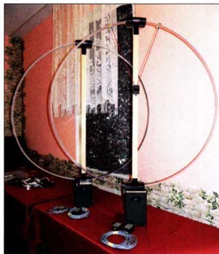
Magnetantennen MSA126 Typ A und B von DL9NBC mit Delta-Match und Strombalun Foto: DL2LQC
