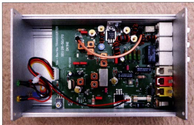
Bild 1: Alle Anschlüsse des Transverters sind als Buchsen ausgeführt, die sich direkt auf der Leiterplatte befinden, sodass sich der Verdrahtungsaufwand auf ein Minimum reduziert. Lediglich die drei LEDs als Statusanzeigen sind auf der Frontplatte über Drähte angebunden.
