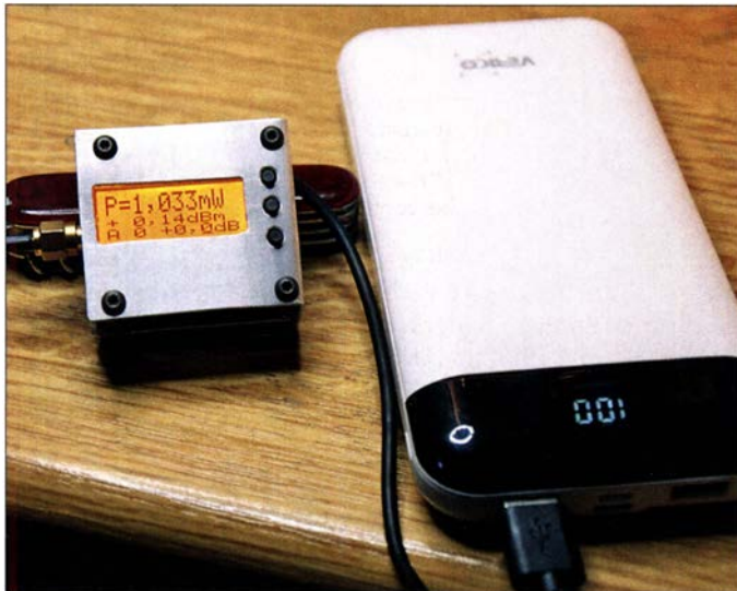
Bild 1: Breitband-Milliwattmeter im Einsatz, hier mit einer 5-V-Powerbank als netzunabhängiger Spannungsversorgung
