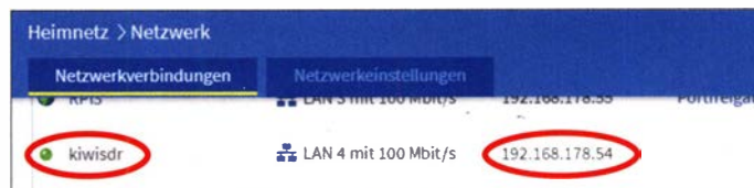
Bild 3: Beispiel für die Anzeige der IP-Adresse des BeagleBone-Computers und damit des KiwiSDR im Router
