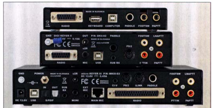
Bild 5: Microham DXP, Digi Keyer II und Micro Keyer III, hier auf die Rückseiten gesehen Fotos: DL2RUM
