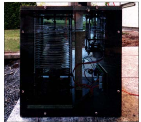
Mit zwei parallelgeschalteten Drehkondensatoren bestückte mikroprozessorgesteuerte Anpassseinheit für die MSA126 Foto: DL9NBC
