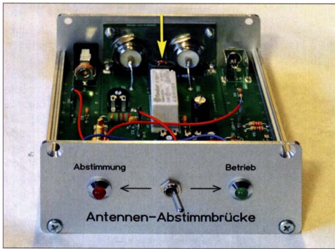
Bild 1: Musteraufbau der Abstimmbrücke im aufgeschraubten Gehäuse; der Übertrager T1 (Pfeil) befindet sich unmittelbar hinter dem Relais. Zur Kontaktierung der SO239-Buchsen dient die Zusatzplatine an der Rückwand.
